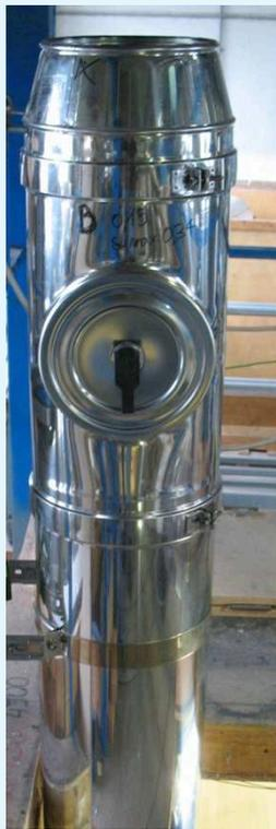
**Fotografie della campionatura dopo la prova di resistenza al calore.**
